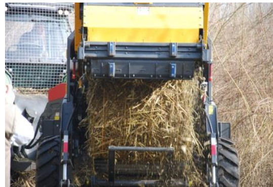
Ouverture de la chambre de compression avant éjection de la balle
