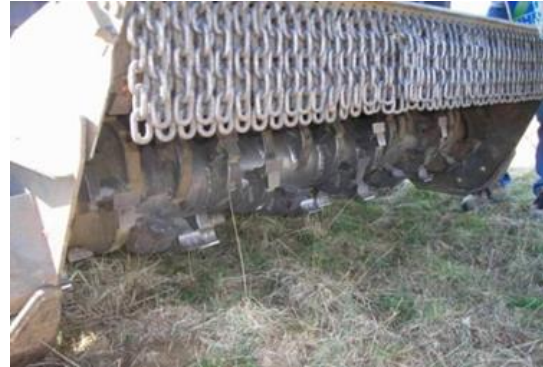
Chaîne de protection et rotor équipé de marteaux
